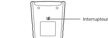
N'essayez pas de changer la position de l'interrupteur après avoir effectué les pré-réglages. Les codes de marques pré-réglés risqueraient d'être effacés.
