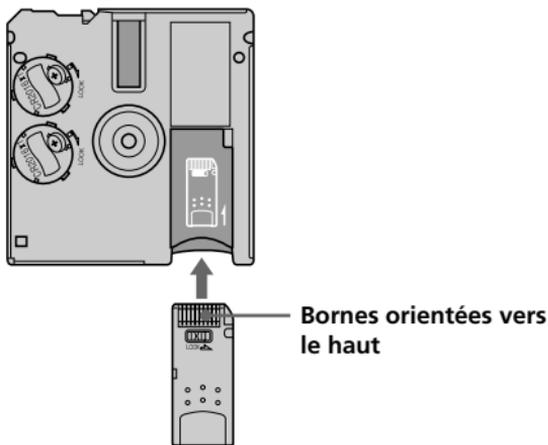
Lorsque vous insérez le « Memory Stick », assurez-vous qu'il siège correctement dans l'adaptateur, sinon il ne fonctionnera pas comme il doit.
